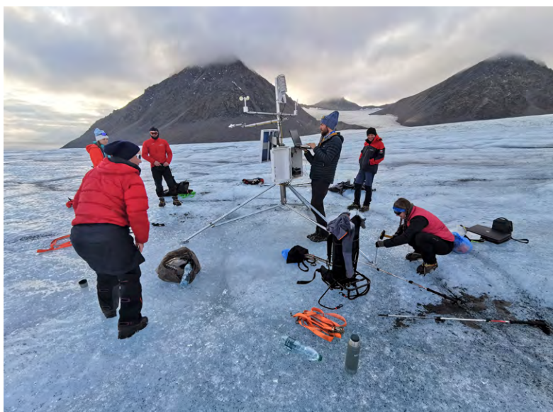
Instalacja automatycznej stacji meteorologicznej w ramach projektu CRIOS na lodowcu Hansa umożliwiającej dostęp do danych w czasie rzeczywistym poprzez satelitarny transfer danych | fot. Dariusz Ignatiuk
