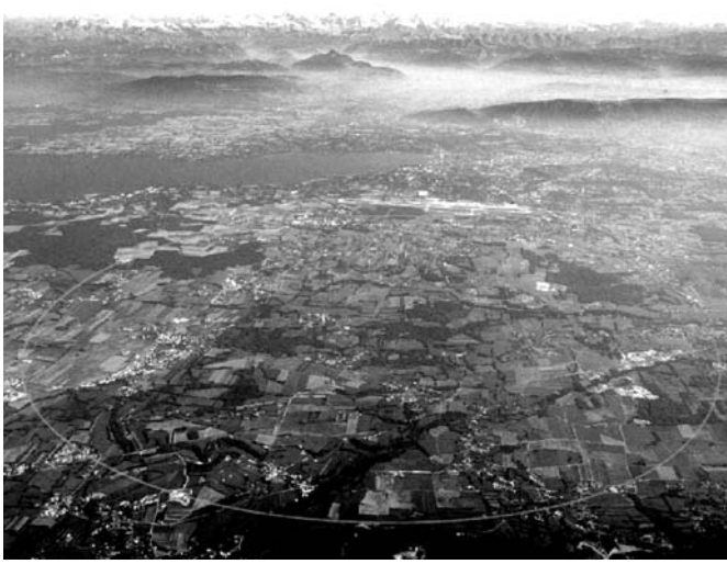
Rys. 2. Po lewej stronie przedstawiony jest plan LHC w CERN. Krzywa pokazuje ulokowany 100 m pod ziemią tunel o długości prawie 27 km. W tunelu tym umieszczone są dipole (zdjęcie po prawej stronie), w których bardzo silne, zmienne pole elektryczne przyspiesza protony lub jony ołowiu w jedną i drugą stronę oraz potężne pole magnetyczne utrzymujące zakrzywioną wiązkę cząstek wewnątrz pierścienia.
